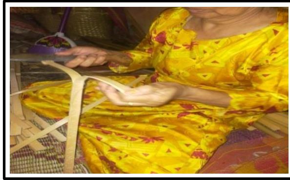
Gambar 4.2 Proses perautan bambu menjadi tipis
