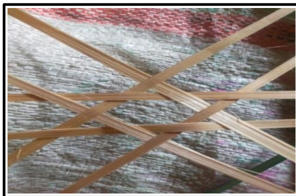
Gambar 4.10 Proses mengayam motif matahari atau terawang
